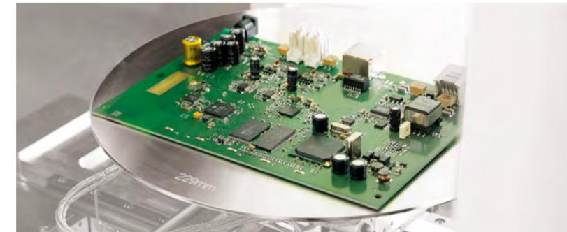
Proben bis 229mm Durchmesser können vollständig begutachtet werden (SU3900)
