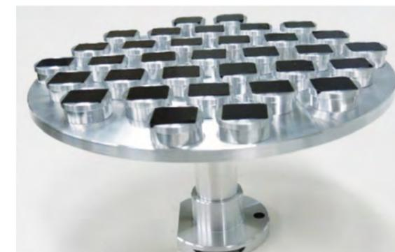
Mehrfach-Probenhalter für 33 x 15mm  $\varnothing$  Teller
